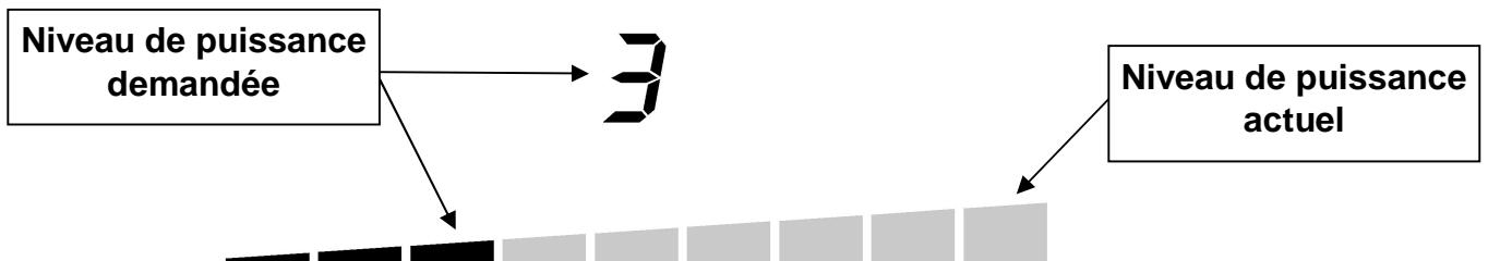
Les segments de l'affichage du niveau de puissance s'éteignent un par un jusqu'au niveau de puissance demandé.
